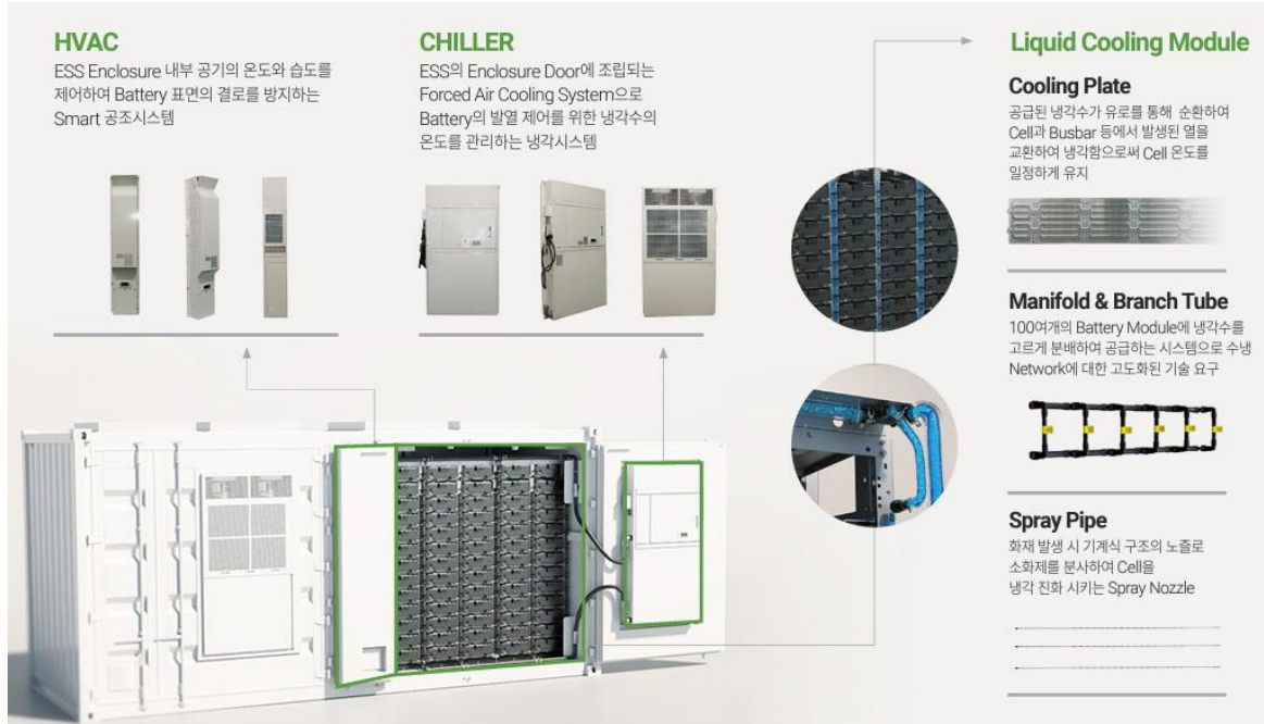
[도표 4] 한중엔시에스 수냉식 ESS 냉각시스템 핵심 제품
